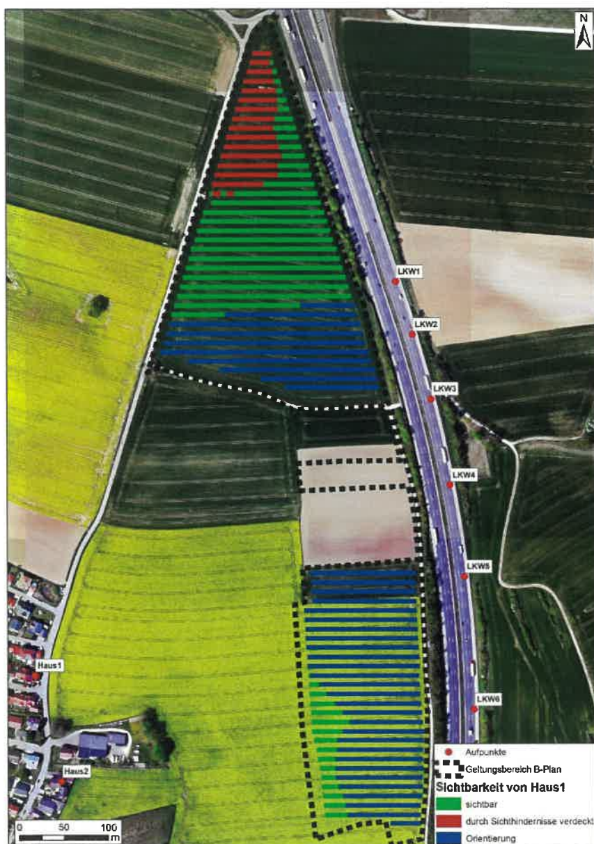
Abb. 6.2: PV-Module, die von dem Aufpunkt Haus1 sichtbar sind
