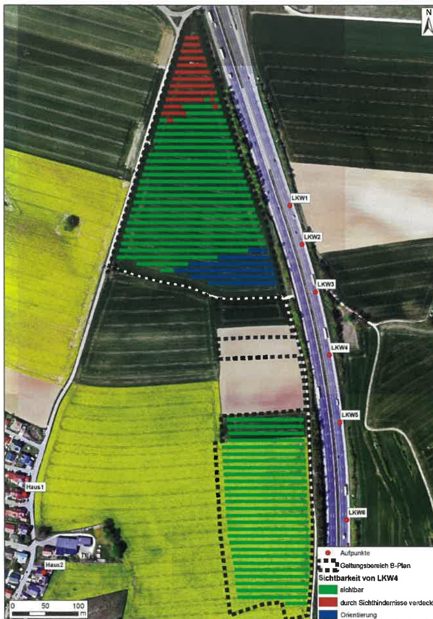
Abb. 6.3: PV-Module, die von dem Aufpunkt LKW4 sichtbar sind
