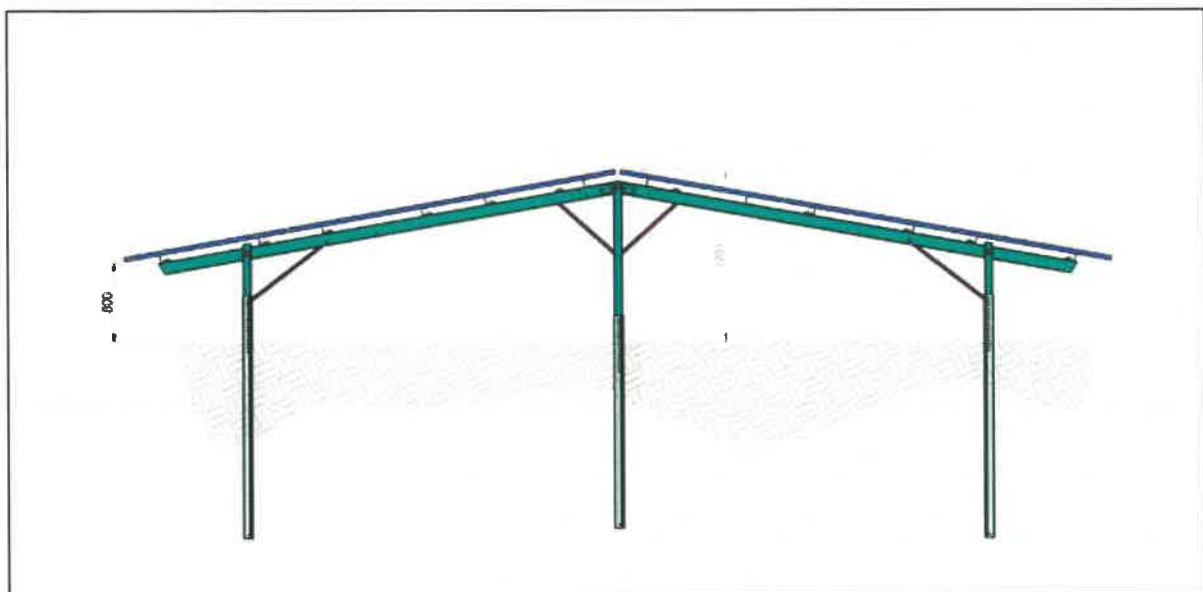
Abb. 5.4: Schema eines PV-Modultisches bei Ost-West-Ausrichtung (Quelle: Auftraggeber)
